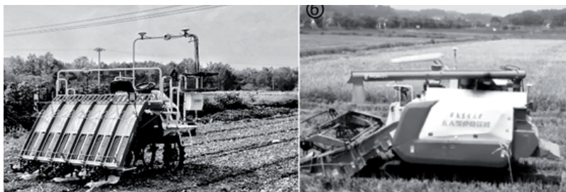
Рис. 8.2.5. Беспилотный сельскохозяйственный трактор с установленным на нем роторным культиватором для посадки риса (а) и крупногабаритный беспилотный комбайн для сбора урожая риса и других зерновых культур (б).
