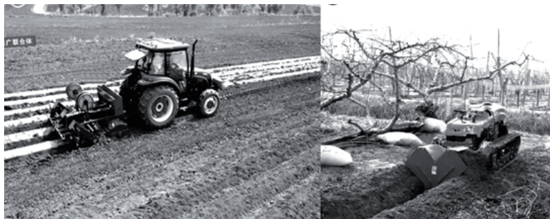
Рис. 8.2.6. Использование интеллектуальной сельскохозяйственной техники для всего процесса вспашки, посадки, управления и сбора урожая сладкого картофеля в холмистой местности (а) и многофункциональная беспилотная роторная культиваторная машина для рыхления почвы и обработки канав в садах (б).
